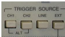
Outro controle importante é o “trigger”. Ele seleciona qual sinal será usado para sincronizar o que se mostra na tela do osciloscópio. Quando o nível do sinal selecionado estiver muito baixo ou muito alto, as formas de onda apresentadas pelo osciloscópio não se estabilizam e estas ficam se movendo horizontalmente. Muitas vezes se estabiliza este problema ajustando o botão “level”.
