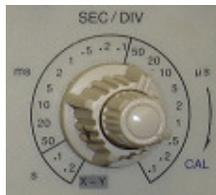
4- Coloque as escalas verticais no seus valores máximo (10V/div) escala horizontal em 1 ms/div. A escala horizontal é responsável por ditar qual a velocidade com que o feixe se desloca na tela. Uma escala de 1 ms/div faz com que o feixe leve  $10^{-3}$  segundos para se deslocar um centímetro no sentido horizontal.
